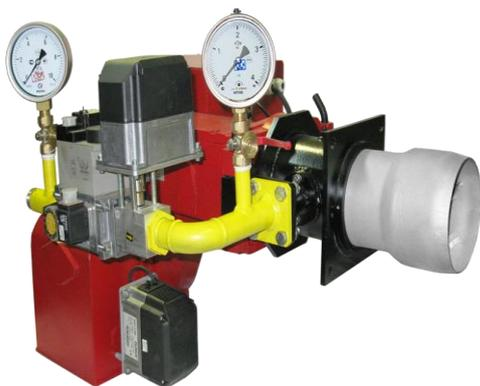
Горелка ГБд-0,34 предназначена для комплектации автоматизированных отопительных котлов и других тепловых агрегатов номинальной тепловой мощностью до 0,3 МВт с камерами горения диаметром не менее 0,35 м и длиной не менее 0,8 м, работающими с номинальным давлением в топке до 200 Па.
