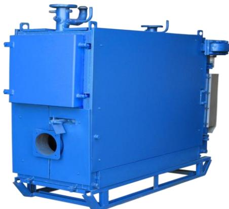
Котел стальной водогрейный автоматизированный КСВа-0,5 предназначен для теплоснабжения жилых, общественных и промышленных зданий и сооружений с рабочим давлением воды в системе не выше 0,6 Мпа (6,0 кгс/кв.см) и максимальной температурой нагрева воды 105 °С.
