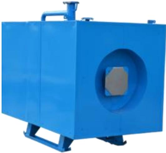
Котел КСВа-2,0 предназначен для теплоснабжения жилых, общественных и промышленных зданий и сооружений с рабочим давлением воды в системе не выше 0,6 Мпа (6,0 кгс/кв.см) и максимальной температурой нагрева воды 115 °С.
